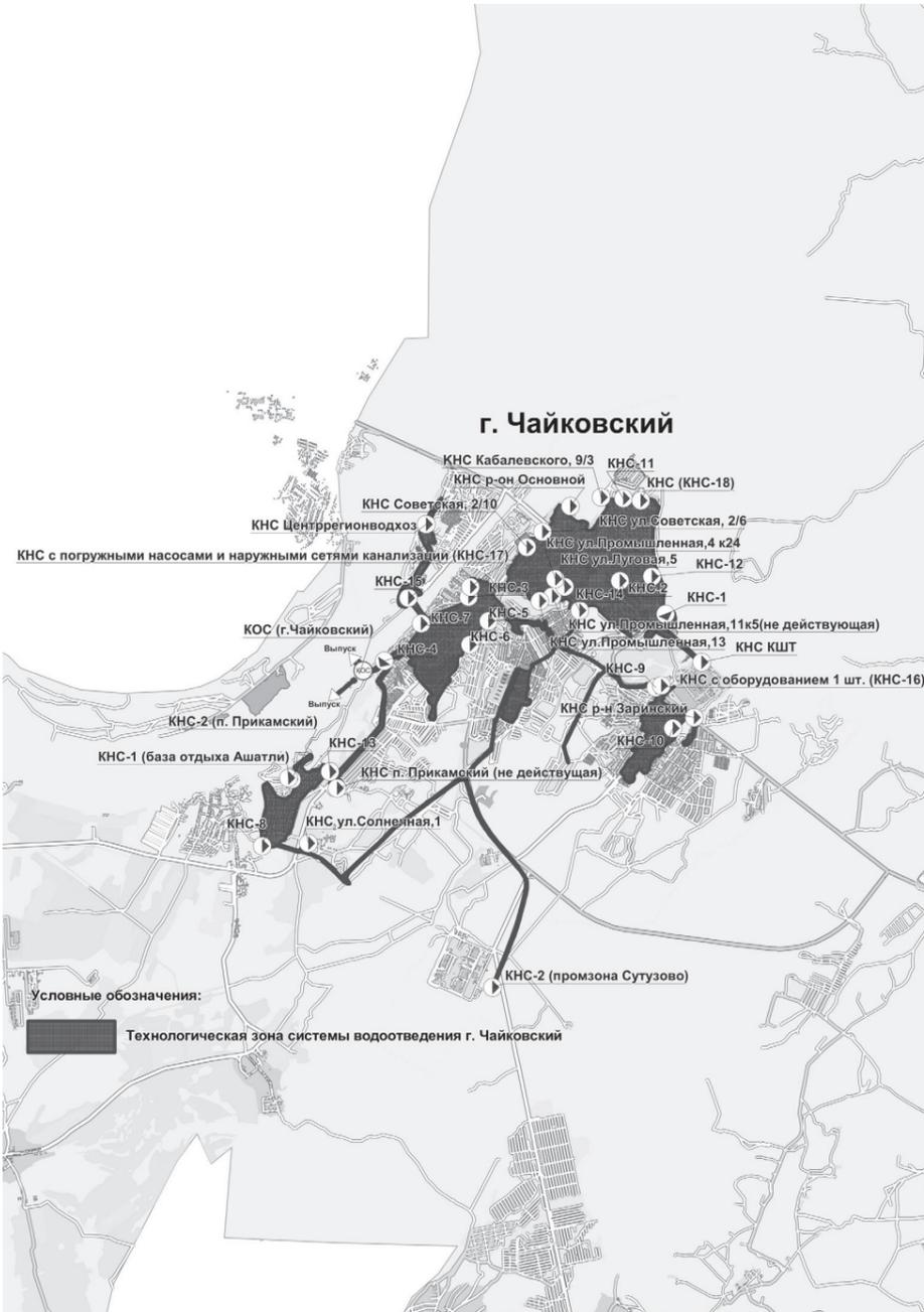
Рисунок 2.9. Технологические зоны системы водоотведения г. Чайковский
