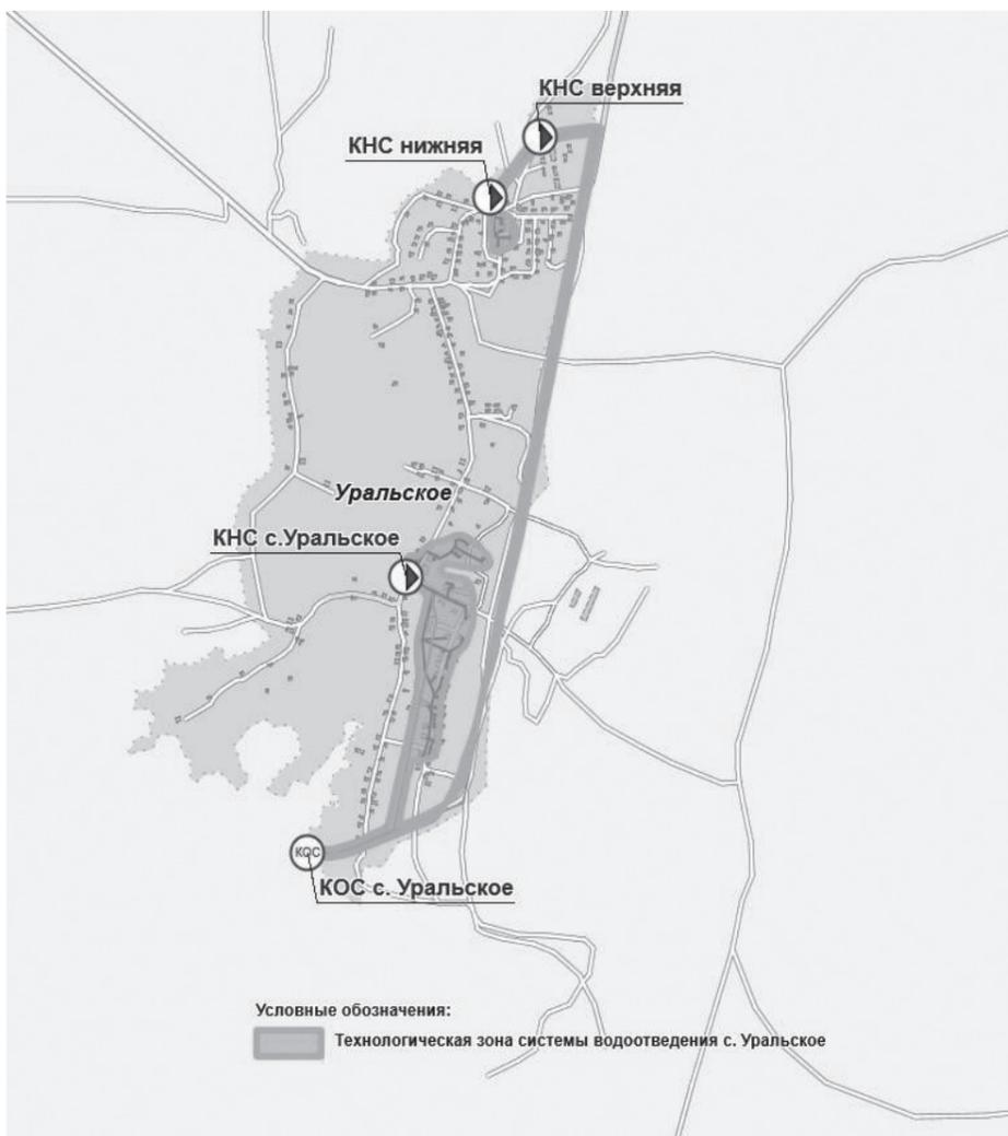
Рисунок 2.14. Технологическая зона системы водоотведения с. Уральское
